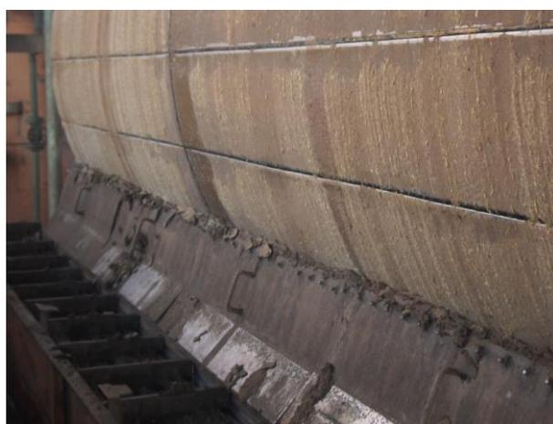
Figura 6: Torta de Filtro na saída de filtros rotativos de uma usina de etanol situado no estado de Goiás.
