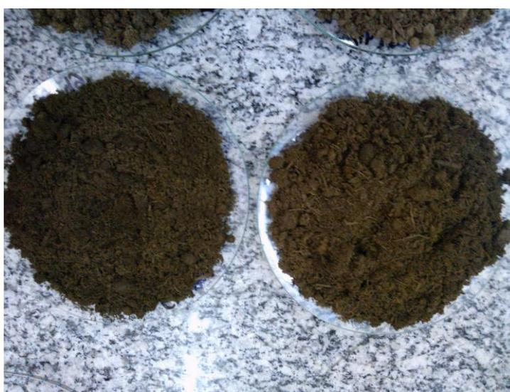
Figura 12: Hidrocarvão seco em estufa a  $60\text{ }^{\circ}\text{C}$ .
