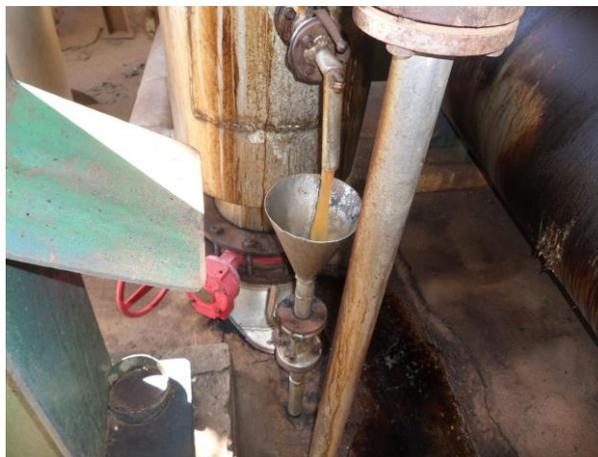
Figura 05: Saída de vinhaça da bica de destilação em uma usina de etanol situado no estado de Goiás.
